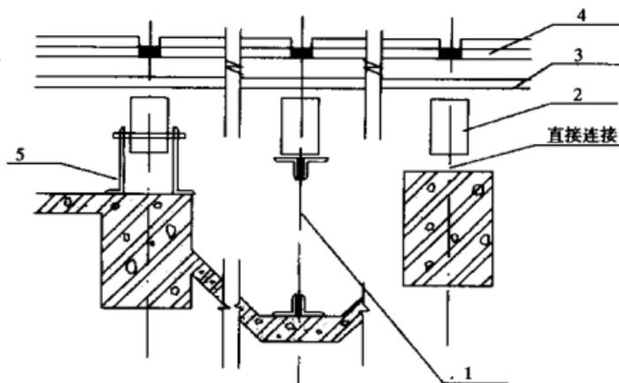
图 5.2 立柱与主体结构连接方式
