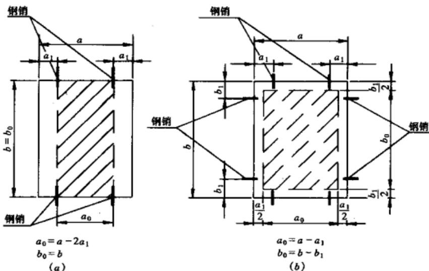
图 5.5.3 钢销连接石板的计算边长  $a_0$ 、 $b_0$
